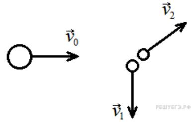
Скорость второго осколка равна  $v_2 = \sqrt{v_{2x}^2 + v_{2y}^2} = \sqrt{(2v_0)^2 + v_1^2} = \sqrt{(2 \cdot 200)^2 + 300^2} = 500$  м/с
