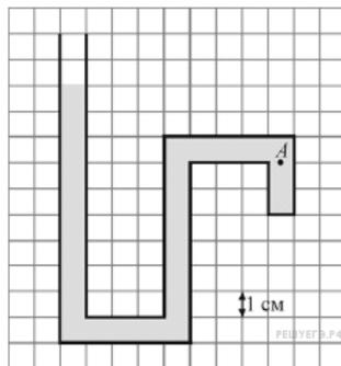
12. В сосуд высотой 20 см налита вода, уровень которой ниже края сосуда на 2 см. Чему равна сила давления воды на дно сосуда, если площадь дна  $0,01 \text{ м}^2$ ? (Ответ дайте в ньютонах.) Атмосферное давление не учитывать. Ускорение свободного падения принять равным  $10 \text{ м/с}^2$ .
