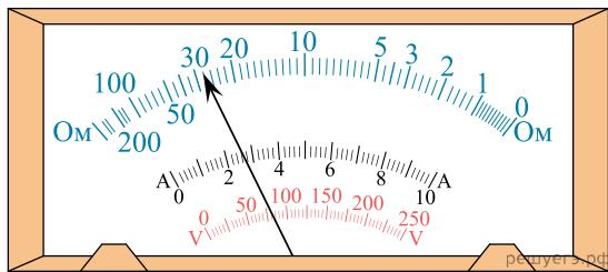
Пользуясь фотографией, определите силу тока, измеряемую с помощью мультиметра, если погрешность прямого измерения силы тока равна цене деления шкалы амперметра. В ответе запишите значение и погрешность слитно без пробелов.
