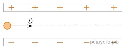
Расстояние между пластинами конденсатора составляет 1 см, длина пластин — 5 см, разность потенциалов между пластинами — 50 В. Чему должна быть равна минимальная скорость, с которой протон влетает в конденсатор, чтобы он смог пролететь его насквозь? Силой тяжести пренебречь.
