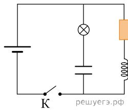
В начальный момент времени ключ  $K$  замкнут. Какая энергия выделится в лампе после размыкания ключа? Внутренним сопротивлением источника тока, и проводов пренебречь.
