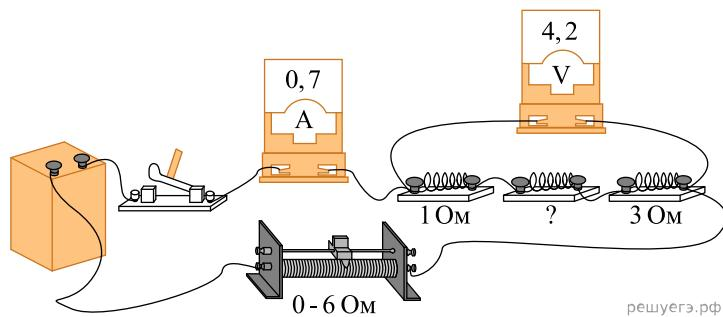
Чему равно сопротивление неизвестного резистора? Вольтметр и амперметр считать идеальными.
