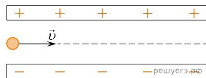
Минимальная скорость  $v$ , с которой протон должен влететь в конденсатор, чтобы затем вылететь из него, равна 350 км/с. Длина пластин конденсатора 5 см, расстояние между пластинами 1 см. Какова напряженность электрического поля конденсатора? Поле внутри конденсатора считать однородным, силой тяжести пренебречь.
