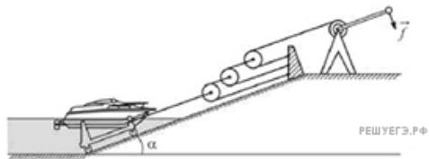
Найдите максимальное водоизмещение судна, которое можно медленно вытащить из воды при помощи показанной на рисунке системы простых механизмов, если лебедка дает выигрыш в силе в  $n = 5$  раз, к ее ручке прикладывают максимальную силу  $f = 250\text{Н}$ , а угол наклона слипа к горизонту равен  $\alpha = 0,1 \text{ рад}$ . Трением можно пренебречь.
