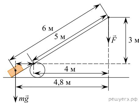
Если модуль силы  $F$  равен 300 Н, а груз на плоскость не давит, то каков модуль силы тяжести, действующей на груз? (Ответ дайте в ньютонах.)
