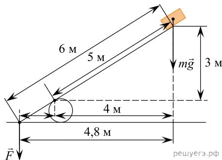
Если модуль силы  $F$  равен 150 Н, а груз на плоскость не давит, то каков модуль силы тяжести, действующей на груз? (Ответ дайте в ньютонах.)
