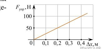
23. На легкой пружине подвешен груз массой 2 кг. В состоянии покоя он растягивает пружину на 4 см. Какой груз следует дополнительно подвесить к этой пружине, чтобы ее удлинение увеличилось на 5 см? Ответ запишите в килограммах.
