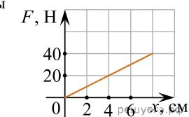
17. Определите силу, под действием которой пружина жесткостью 200 Н/м удлинится на 5 см.
