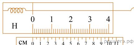
Шкала проградуирована в ньютонах. Каким будет растяжение пружины динамометра, если к ней подвесить груз массой  $200 \text{ г}$ ? (Ответ дайте в сантиметрах.) Ускорение свободного падения считать равным  $10 \text{ м/с}^2$ .
