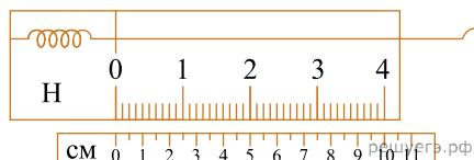
Шкала проградуирована в ньютонах. Какой должна быть масса груза, подвешенного к пружине, чтобы она растянулась на 2,5 см? *Ответ запишите в граммах.*
