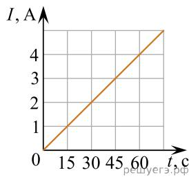
28. На графике показана зависимость силы тока в проводнике от времени. Определите заряд, прошедший через поперечное сечение проводника за  $\Delta t = 6$  с. Ответ запишите в кулонах.
