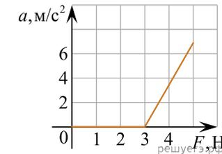
18. Массивный груз, покоящийся на горизонтальной опоре, привязан к легкой нерастяжимой веревке, перекинутой через идеальный блок. К веревке прикладывают постоянную силу  $\vec{F}$ , направленную под углом  $\alpha = 45^\circ$  к горизонту (см. рисунок). Зависимость модуля ускорения груза от модуля силы  $\vec{F}$  представлена на графике. Чему равна масса груза? (Ответ дайте в килограммах с точностью до десятых.)
