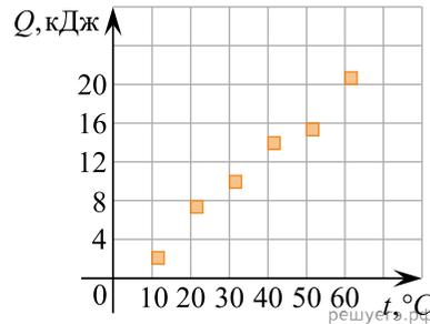
16. Серебро массой  $100$  г с начальной температурой  $0^\circ\text{C}$  нагревают в тигле на электропечи мощностью  $50$  Вт. На рисунке приведен экспериментально полученный график зависимости температуры  $T$  серебра от времени  $t$ . Считая, что вся теплота, поступающая от электропечи, идет на нагрев серебра, определите его удельную теплоемкость. Ответ дайте в Дж/(кг·°C) с точностью до  $10$  Дж/(кг·°C).
