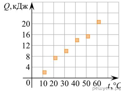
15. На графике представлены результаты измерения количества теплоты  $Q$ , затраченного на нагревание 1 кг некоторого вещества от  $0^\circ\text{C}$  до различных температур  $t$ . Погрешность измерения количества теплоты  $\Delta Q = \pm 400$  Дж, температуры  $\Delta t = \pm 2$  К.
