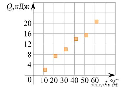
14. На графике представлены результаты измерения количества теплоты  $Q$ , затраченного на нагревание 1 кг некоторого вещества от  $0^\circ\text{C}$  до различных температур  $t$ . Погрешность измерения количества теплоты  $\Delta Q = \pm 400$  Дж, температуры  $\Delta t = \pm 2$  К.
