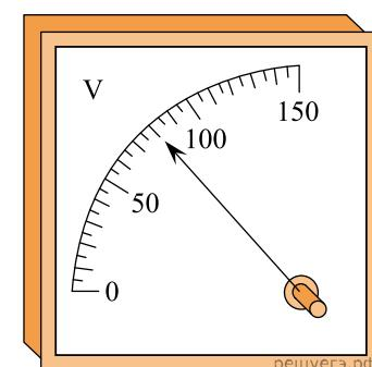
**24.** При помощи вольтметра измеряется напряжение в некоторой электрической цепи. Вольтметр изображен на рисунке. Чему равно напряжение в цепи, если погрешность прямого измерения напряжения составляет половину цены деления вольтметра? Ответ приведите в вольтах. В ответе запишите значение и погрешность слитно без пробела.
