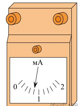
**26.** При помощи миллиамперметра измеряется ток в некоторой электрической цепи. Миллиамперметр изображен на рисунке. Чему равен ток в цепи, если погрешность прямого измерения тока составляет половину цены деления миллиамперметра? Ответ приведите в миллиамперах. В ответе запишите значение и погрешность слитно без пробела.
