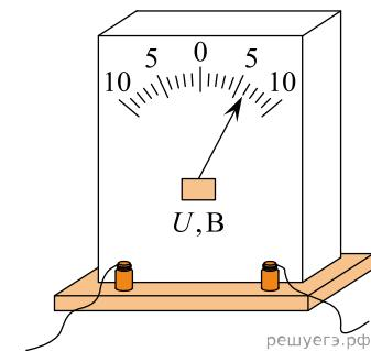
21. При помощи миллиамперметра измеряется ток в некоторой электрической цепи. Миллиамперметр изображен на рисунке. Чему равен ток в цепи, если погрешность прямого измерения тока составляет половину цены деления миллиамперметра? Ответ приведите в миллиамперах. В ответе запишите значение и погрешность слитно без пробела.
