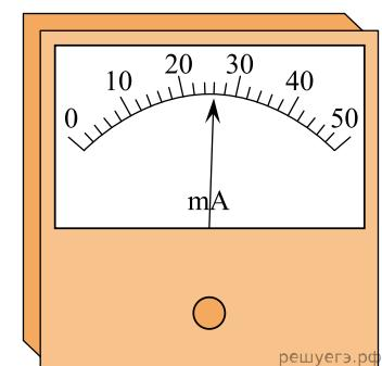
**22.** При помощи миллиамперметра измеряется ток в некоторой электрической цепи. Миллиамперметр изображен на рисунке. Чему равен ток в цепи, если погрешность прямого измерения тока составляет половину цены деления миллиамперметра? Ответ приведите в миллиамперах. В ответе запишите значение и погрешность слитно без пробела.
