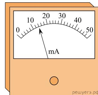
4. При помощи вольтметра измеряется напряжение в некоторой электрической цепи. Вольтметр изображен на рисунке. Чему равно напряжение в цепи, если погрешность прямого измерения напряжения составляет половину цены деления вольтметра? Ответ приведите в вольтах. В ответе запишите значение и погрешность слитно без пробела.
