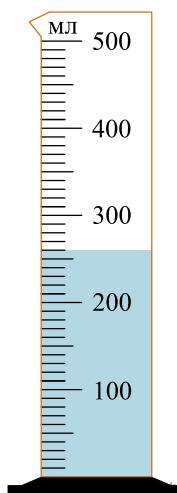
**13.** В мерный стакан налита вода. Укажите объем воды с учетом погрешности измерения, учитывая что погрешность составляет половину цены деления мерного стакана. В ответе запишите значение и погрешность слитно без пробела в миллилитрах.
