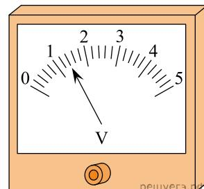
10. Запишите результат измерения электрического напряжения, учитывая, что погрешность равна цене деления. В ответе запишите значение и погрешность слитно без пробела.
