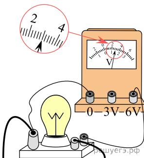
**86.** Чему равно напряжение на резисторе  $R_1$  (см. рисунок), если погрешность прямого измерения напряжения равна цене деления вольтметра?
