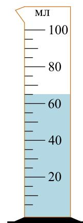
**14.** В мерный стакан налита вода. Укажите объем воды с учетом погрешности измерения, учитывая что погрешность составляет половину цены деления мерного стакана. В ответе запишите значение и погрешность (в мл) слитно без пробела.
