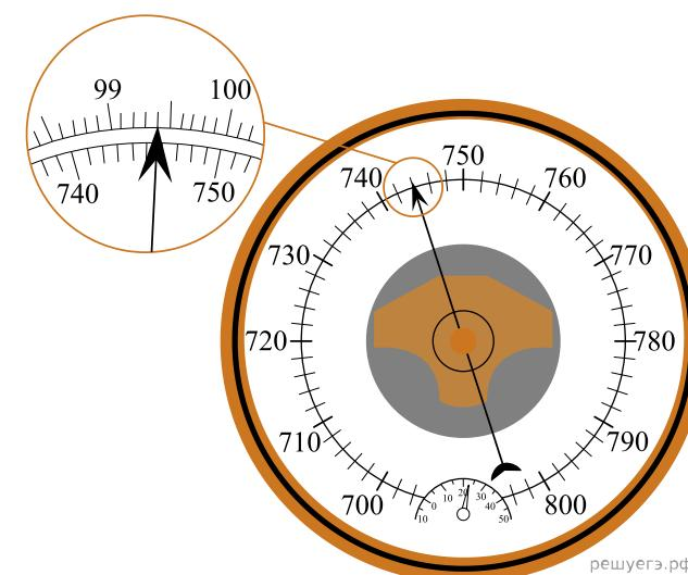
**38.** С помощью барометра проводились измерения атмосферного давления. Верхняя шкала барометра проградуирована в кПа, а нижняя шкала — в мм рт. ст. Погрешность измерений давления равна цене деления шкалы барометра. Запишите в ответ величину атмосферного давления, выраженного в мм рт. ст., с учетом погрешности. *В ответе запишите значение и погрешность слитно без пробела.*
