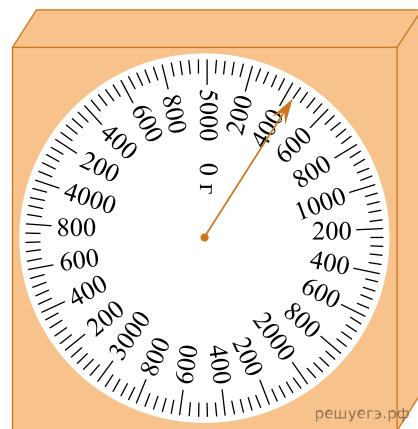
**82.** Динамометр с прикреплённым к нему бруском тянут влево, как показано на рисунке. Брусков движется с постоянной скоростью. Абсолютная погрешность измерения силы при помощи динамометра равна цене деления прибора. Запишите значение силы трения скольжения, действующей на брускок, с учётом абсолютной погрешности измерений.
