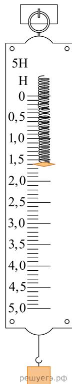
**40.** Ученик измерял силу тяжести, действующую на груз. Показания динамометра приведены на фотографии. Погрешность измерения равна цене деления динамометра. Запишите в ответ величину силы тяжести, действующей на груз, с учетом погрешности измерений. В ответе запишите значение и погрешность слитно без пробела.
