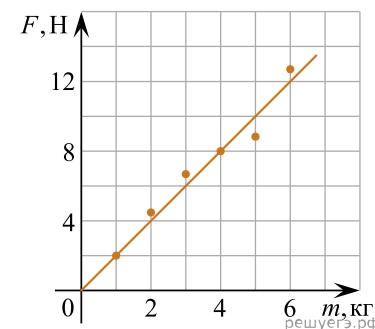
36. Космонавты исследовали зависимость силы тяжести от массы тела на открытой ими планете. Результаты измерений представлены в виде графика на рисунке. Погрешность измерения массы равна 0,1 кг, силы — 1,5 Н. Чему равна с учетом погрешности измерений масса тела, на которое действует сила тяжести, равная 12,5 Н? В ответе запишите значение и погрешность сlitnno без пробела.
