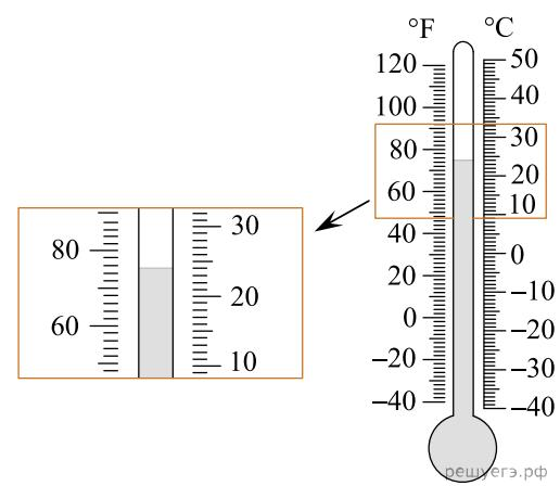
**84.** При помощи термометра, изображенного на рисунке, измеряют температуру воздуха в помещении. Погрешность измерения равна половине цены деления прибора. Чему равна температура воздуха в помещении? *Ответ запишите в градусах Цельсия. Значение и погрешность запишите слитно без пробела.*
