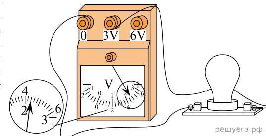
60. Мультиметр — это комбинированный электроизмерительный прибор, объединяющий в себе несколько функций. Он может выполнять функции вольтметра, амперметра и омметра. Определите по фотографии напряжение, измеряемое с помощью мультиметра, если погрешность прямого измерения равна цене деления шкалы вольтметра. Выразите обе величины в вольтах и округлите их до десятых долей.
