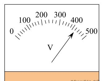
32. Запишите результат измерения электрического напряжения, учитывая, что погрешность равна половине цены деления. В ответе запишите значение и погрешность слитно без пробела.
