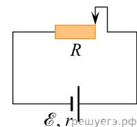
**30.** На рисунке изображена схема электрической цепи, состоящей из последовательно соединенных источника постоянного напряжения с ЭДС  $\mathcal{E}$  и внутренним сопротивлением  $r$  и реостата с полным сопротивлением  $R = r$ . В исходном состоянии kontakt реостата находится в правом положении. Kontakt реостата перемещают влево. Как в результате этого изменяются сила тока в цепи и тепловая мощность, выделяющаяся в реостате?
