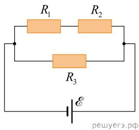
**13.** Какая мощность выделяется в участке цепи, схема которого изображена на рисунке, если  $R = 16 \text{ Ом}$ , а напряжение между точками  $A$  и  $B$  равно 8 В? Ответ приведите в ваттах.
