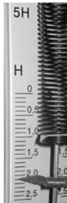
8. Ученик измерял силу тяжести, действующую на груз. Показания динамометра приведены на фотографии. Погрешность измерения равна цене деления динамометра.
