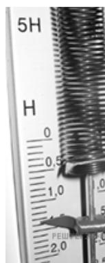
10. Ученик измерял силу тяжести, действующую на груз. Показания динамометра приведены на фотографии. Погрешность измерения равна цене деления динамометра. В каком случае показания динамометра записаны верно?
