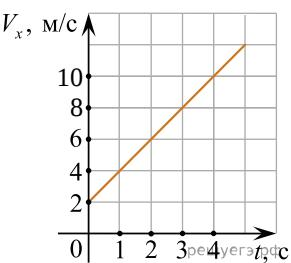
16. На рисунке приведен график зависимости проекции скорости тела  $V_x$  от времени. Чему равна проекция ускорения этого тела  $a_x$  в интервале времени от 8 до 10 с? Ответ запишите в метрах за секунду в квадрате.
