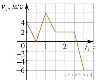
24. На рисунке показан график зависимости от времени для проекции  $v_x$  скорости тела. Какова проекция  $a_x$  ускорения этого тела в интервале времени от 5 до 6 с? Ответ запишите в метрах на секунду в квадрате.
