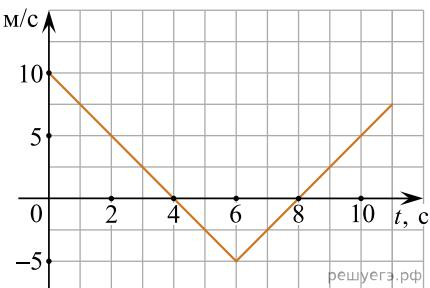
9. Тело движется по оси  $Ox$ . По графику зависимости проекции скорости тела  $v_x$  от времени  $t$  установите, какой путь прошло тело за время от  $t_1 = 0$  до  $t_2 = 8$  с. (Ответ дайте в метрах.)
