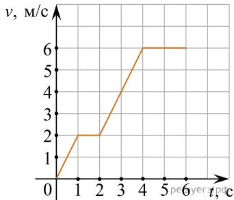
3. На рисунке представлен график зависимости модуля скорости тела от времени. Какой путь пройден телом за вторую секунду? (Ответ дайте в метрах.)
