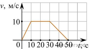
12. На рисунке представлен график зависимости модуля скорости  $v$  автомобиля от времени  $t$ . Определите по графику путь, пройденный автомобилем в интервале времени от 0 до 30 с. (Ответ дайте в метрах.)
