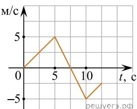
29. На рисунке показана зависимость проекции скорости  $V_x$  точечного тела на ось  $OX$  от времени  $t$ . Определите проекцию ускорения этого тела на ось  $OX$  в интервале времени от 0 до 3 с.
