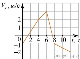
30. Тело движется вдоль оси  $Ox$ . По графику зависимости проекции скорости тела  $v_x$  от времени  $t$  установите модуль перемещения тела за время от  $t_1 = 6$  с до  $t_2 = 10$  с.
