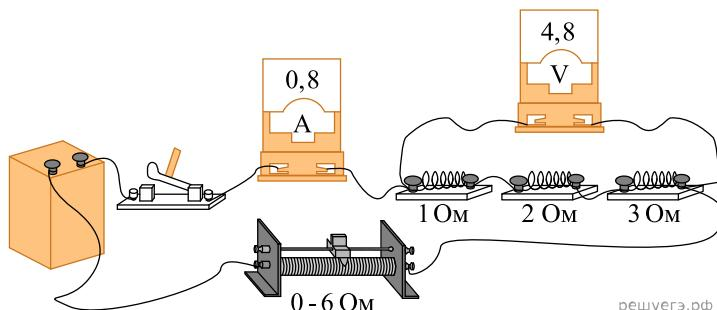
Чему будут равны показания вольтметра, если его переподключить к резистору с сопротивлением 1 Ом? Вольтметр и амперметр считать идеальными. *Ответ запишите в вольтах.*
