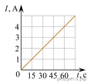
28. На графике показана зависимость силы тока в проводнике от времени. Определите заряд, прошедший через поперечное сечение проводника за  $\Delta t = 6$  с. *Ответ запишите в кулонах.*
