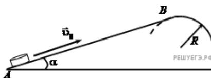
В точке  $B$  наклонная плоскость без излома переходит в наружную поверхность горизонтальной трубы радиусом  $R$ . Если в точке  $A$  скорость шайбы превосходит  $v_0 = 4 \text{ м/с}$ , то в точке  $B$  шайба отрывается от опоры. Длина наклонной плоскости  $AB = L = 1 \text{ м}$ , угол  $\alpha = 30^\circ$ . Коэффициент трения между наклонной плоскостью и шайбой  $\mu = 0,2$ . Найдите внешний радиус трубы  $R$ .
