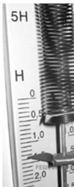
**10.** Ученик измерял силу тяжести, действующую на груз. Показания динамометра приведены на фотографии. Погрешность измерения равна цене деления динамометра. В каком случае показания динамометра записаны верно?
