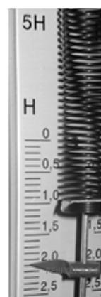
**8.** Ученик измерял силу тяжести, действующую на груз. Показания динамометра приведены на фотографии. Погрешность измерения равна цене деления динамометра.
