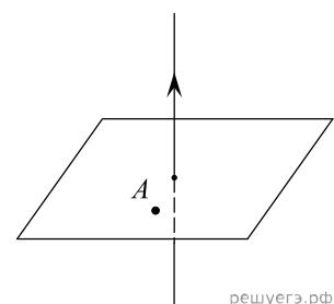
21. На рисунке изображен проволочный виток, по которому течет электрический ток в направлении, указанном стрелкой. Виток расположен в вертикальной плоскости. Как направлен (вправо, влево, вверх, вниз) вектор индукции магнитного поля тока? Ответ запишите словом.
