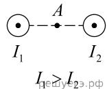
17. На рисунке изображен горизонтальный проводник, по которому течет электрический ток в направлении «от нас». Как направлен (вниз, вверх, влево, вправо) вектор индукции магнитного поля в точке  $A$ ? Ответ запишите словом.
