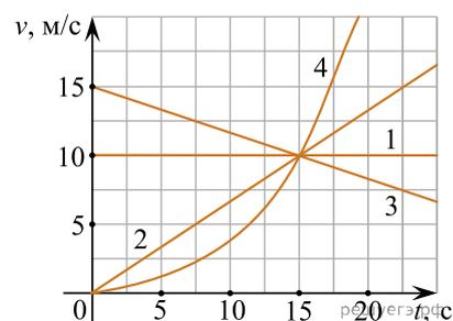
11. На рисунке представлен график зависимости модуля скорости  $\vec{v}$  автомобиля от времени  $t$ . Определите по графику путь, пройденный автомобилем в интервале времени от 30 до 50 с после начала движения. (Ответ дайте в метрах.)
