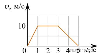
53. На рисунке показан график зависимости проекции  $v_x$  скорости тела от времени  $t$ . Какова проекция  $a_x$  ускорения этого тела в интервале времени от 1 до 2 с? *Ответ запишите в метрах на секунду в квадрате.*
