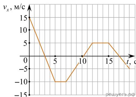
35. Точечное тело движется вдоль оси  $Ox$ . На рисунке изображен график зависимости проекции скорости  $V$  этого тела на указанную ось от времени  $t$ . В момент времени  $t = 0$  с тело находилось в точке с координатой  $x_0 = 4$  м. Определите координату тела в момент времени  $t = 3$  с. Ответ дайте в метрах.
