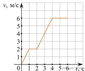
2. На рисунке представлен график зависимости модуля скорости автомобиля от времени. Определите по графику путь, пройденный автомобилем в интервале от момента времени 0 с до момента времени 5 с после начала отсчета времени. (Ответ дайте в метрах.)
