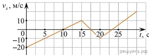
Определите проекцию ускорения этого тела  $a_x$  в интервале времени от 15 до 20 с. Ответ выразите в метрах на секунду в квадрате.
