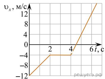
52. На рисунке представлен график зависимости модуля скорости  $v$  тела от времени  $t$ . Определите по графику путь, пройденный телом в интервале времени от 0 до 5 с после начала движения. *Ответ запишите в метрах.*
