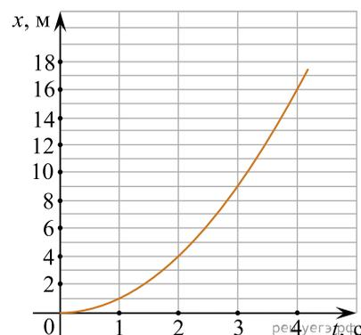
15. Точечное тело движется вдоль оси  $Ox$ . В начальный момент времени тело находилось в точке с координатой  $x = -5$  м. На рисунке изображена зависимость проекции скорости  $V_x$  этого тела от времени  $t$ . Чему равна координата этого тела в момент времени  $t = 4$  с? (Ответ дайте в метрах.)
