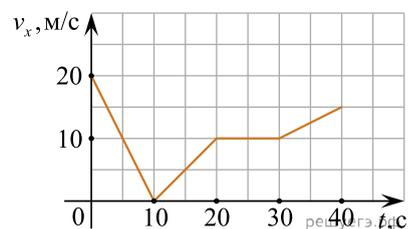
40. На рисунке приведен график зависимости проекции  $v_x$  скорости тела от времени  $t$ . Определите проекцию  $a_x$  ускорения этого тела в интервале времени от 20 до 30 с. Ответ запишите в метрах на секунду в квадрате.
