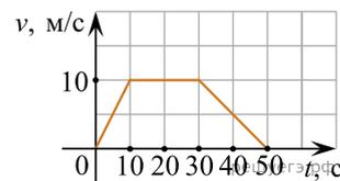
12. На рисунке представлен график зависимости модуля скорости  $v$  автомобиля от времени  $t$ . Определите по графику путь, пройденный автомобилем в интервале времени от 0 до 30 с. (Ответ дайте в метрах.)
