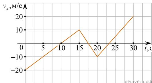
41. На рисунке представлен график зависимости проекции скорости  $v_x$  от времени  $t$  движения тела. Чему равна проекция ускорения? Ответ дайте в метрах на секунду в квадрате.
