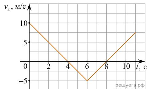
9. Тело движется по оси  $Ox$ . По графику зависимости проекции скорости тела  $v_x$  от времени  $t$  установите, какой путь прошло тело за время от  $t_1 = 0$  до  $t_2 = 8$  с. (Ответ дайте в метрах.)
