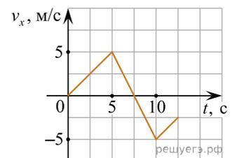
29. На рисунке показана зависимость проекции скорости  $V_x$  точечного тела на ось  $OX$  от времени  $t$ . Определите проекцию ускорения этого тела на ось  $OX$  в интервале времени от 0 до 3 с.
