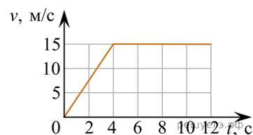
56. На рисунке представлен график зависимости проекции  $v_x$  скорости тела от времени  $t$ . Чему равна проекция  $s_x$  перемещения этого тела за время от момента  $t_1 = 0,5$  с до момента  $t_2 = 1,5$  с? *Ответ запишите в метрах с учётом знака проекции.*
