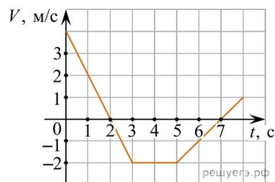
21. На рисунке показан график зависимости от времени для проекции  $v_x$  скорости тела. Какова проекция  $a_x$  ускорения этого тела в интервале времени от 4 до 8 с?
