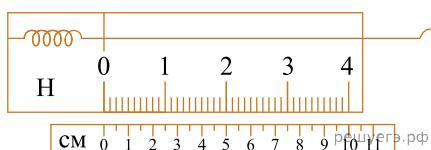
Шкала проградуирована в ньютонах. Какой должна быть масса груза, подвешенного к пружине, чтобы она растянулась на 2,5 см? *Ответ запишите в граммах.*
