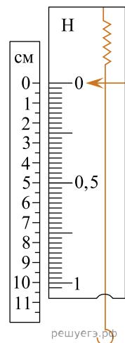
31. Пружина жесткостью  $2 \cdot 10^4 \text{ Н/м}$  одним концом закреплена в штативе. На какую величину она растянется, если к ней подвесить груз массой 2 кг? *Ответ запишите в сантиметрах.*
