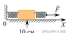
15. Кубик массой 2 кг поконится на гладком горизонтальном столе, сжатый с боков пружинами (см. рис.). Левая пружина жесткостью  $k_1 = 500 \text{ Н/м}$  сжата на 3 см. С какой силой правая пружина действует на кубик? Ответ приведите в ньютонах.
