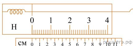
Шкала проградуирована в ньютонах. Каким будет растяжение пружины динамометра, если к ней подвесить груз массой 200 г? (Ответ дайте в сантиметрах.) Ускорение свободного падения считать равным  $10 \text{ м/с}^2$ .
