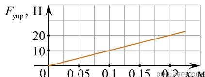
8. Ученик собрал установку, представленную на рисунке слева, и подвесил груз массой 0,1 кг (рис. справа). Какова жесткость пружины? (Ответ дайте в ньютонах на метр.) Ускорение свободного падения принять равным  $10 \text{ м/с}^2$ .
