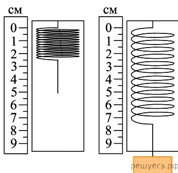
9. После того как груз массой 600 г аккуратно отцепили от груза  $m$ , пружина сжалась так, как показано на рисунке, и система пришла в равновесие. Пренебрегая трением, определите, чему равен коэффициент жесткости пружины. (Ответ дайте в ньютонах на метр.) Нить считайте невесомой. Ускорение свободного падения принять равным  $10 \text{ м/с}^2$ .
