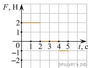
**18.** Материальная точка массой 2 кг движется вдоль горизонтальной оси  $Ox$  под действием горизонтальной силы  $F$ . В начальный момент времени тело покоилось. График зависимости силы  $F$  от времени  $t$  изображен на рисунке. Чему равен импульс материальной точки в конце второй секунды? (Ответ дайте в килограммах на метр в секунду.)
