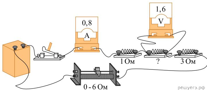
Какими станут показания вольтметра, если подключить его к резистору сопротивлением 3 Ом? Вольтметр и амперметр считать идеальными. Ответ запишите в вольтах.
