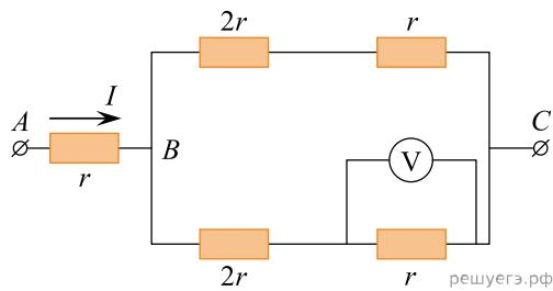
**30.** Пять одинаковых резисторов с сопротивлением  $r = 1$  Ом соединены в электрическую цепь, схема которой представлена на рисунке. По участку *AB* течет ток  $I = 4$  А. Какое напряжение показывает идеальный вольтметр? (Ответ дайте в вольтах.)
