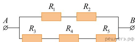
**32.** Пять одинаковых резисторов с сопротивлением  $r = 4$  Ом соединены в электрическую цепь, схема которой представлена на рисунке. По участку  $AB$  идет ток  $I = 4$  А. Какое напряжение показывает идеальный вольтметр?
