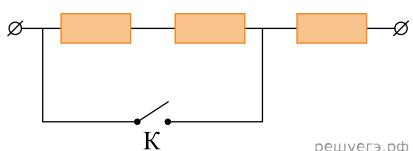
14. На участке цепи, изображенном на рисунке, сопротивление каждого из резисторов равно  $R = 1 \text{ Ом}$ . Чему равно полное сопротивление участка при замкнутом ключе K?
