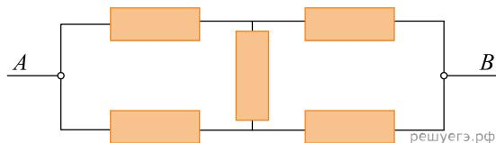
**26.** Источник тока имеет ЭДС  $\mathcal{E} = 6$  В, внутреннее сопротивление  $r = 1$  Ом,  $R_1 = 1$  Ом,  $R_2 = R_3 = 2$  Ом. Какой силы ток течет через источник? (Ответ дайте в амперах.)
