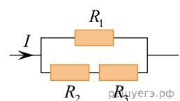
**41.** Электрический ток, поступающий в цепь  $I_0 = 4$  А. Сопротивление каждого резистора 1 Ом. Найдите показание вольтметра, изображенного на рисунке.
