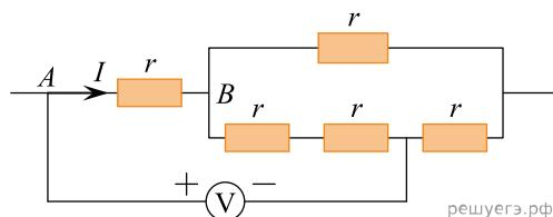
**31.** Сопротивление каждого резистора в цепи на рисунке равно 100 Ом. Чему равно напряжение на резисторе  $R_2$  при подключении участка к источнику постоянного напряжения 12 В выводами  $A$  и  $B$ ? (Ответ дайте в вольтах.)
