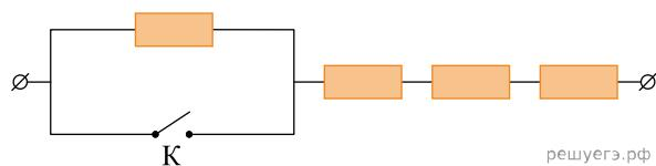
15. На участке цепи, изображенном на рисунке, сопротивление каждого из резисторов равно  $R = 1 \text{ Ом}$ . Чему равно полное сопротивление участка при замкнутом ключе K?
