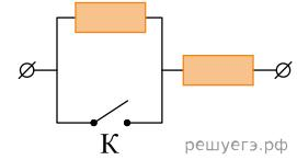
12. На участке цепи, изображенном на рисунке, сопротивление каждого из резисторов равно  $R = 1 \text{ Ом}$ . Чему равно полное сопротивление участка при замкнутом ключе K?
