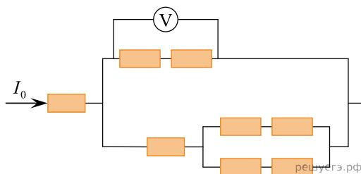
**42.** Пять одинаковых резисторов с сопротивлением  $R = 1$  Ом соединены в электрическую цепь, через которую течет ток  $I = 2$  А (см. рис.). Какое напряжение показывает идеальный вольтметр?
