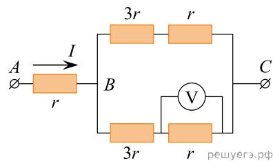
**29.** На рисунке показана схема участка электрической цепи. По участку *AB* течет постоянный ток  $I = 6$  А. Какое напряжение показывает идеальный вольтметр, если сопротивление  $r = 1$  Ом? (Ответ дайте в вольтах.)
