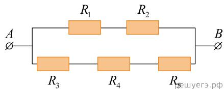
**28.** На рисунке показана схема участка электрической цепи. По участку *AB* течет постоянный ток  $I = 4$  А. Какое напряжение показывает идеальный вольтметр, если сопротивление  $r = 1$  Ом? (Ответ дайте в вольтах.)
