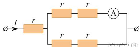
**37.** Через участок цепи (см. рис.) течет постоянный ток  $I = 4$  А. Какую силу тока покажет включенный в эту цепь идеальный амперметр, если сопротивление каждого резистора  $r = 1$  Ом? Ответ выразите в амперах.
