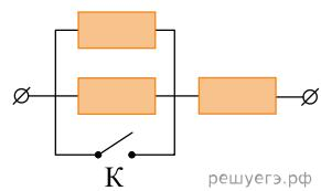
7. На участке цепи, изображенном на рисунке, сопротивление каждого из резисторов равно  $R = 12 \text{ Ом}$ . Чему равно полное сопротивление участка при замкнутом ключе K?
