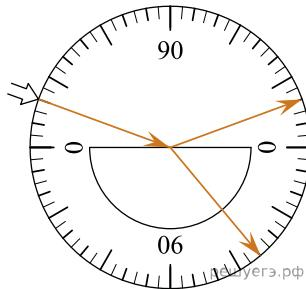
2. При переходе луча света из одной среды в другую угол падения равен  $53^\circ$ , а угол преломления  $37^\circ$  ( $\sin 37^\circ = 0,6$ ,  $\sin 53^\circ = 0,8$ ). Каков относительный показатель преломления второй среды относительно первой? (Ответ округлить до сотых.)
